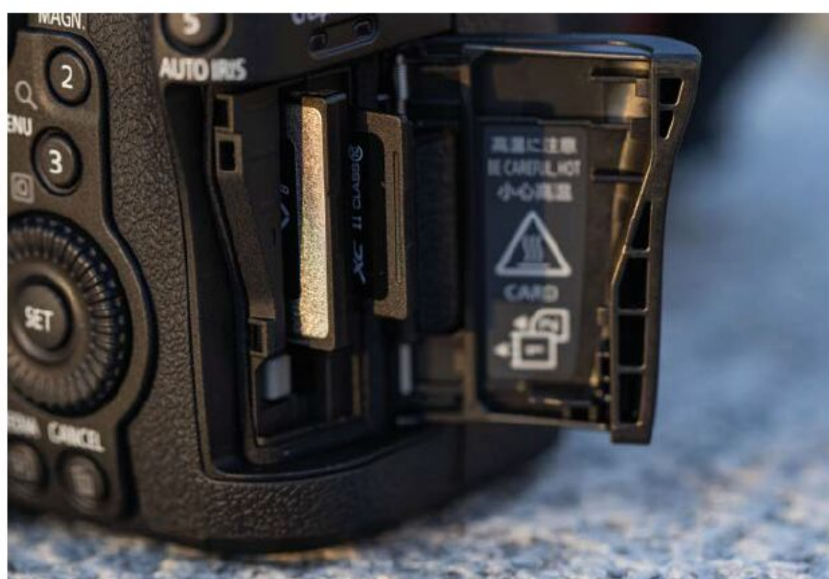
↑ Die EOS C50 besitzt zwei Speicherkartenschächte: einen für schnelle CFexpress-Karten des Typs B und einen für SD-Karten.
