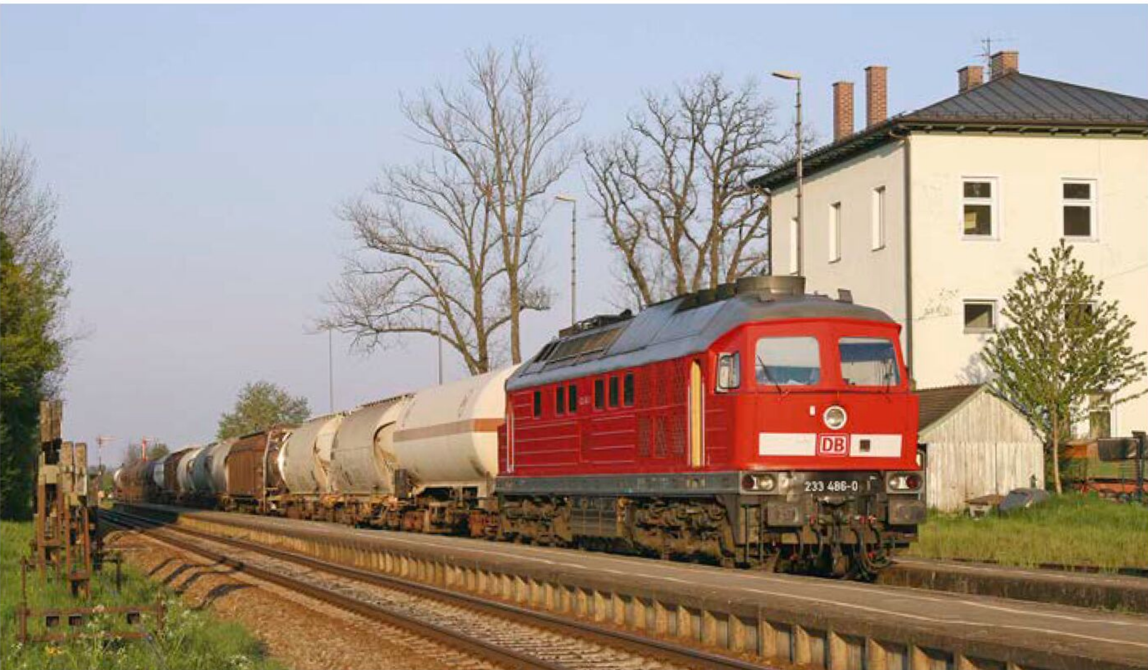
Auch auf dem Gebiet der früheren DB wurden die Dieselloks aus sowjetischer Produktion heimisch: Im südostbayerischen Chemiedreieck konnten die mit einem 3600PS-Motor versehenen Loks der Baureihe 233 ihre Stärken ausspielen. Am Abend des 25. April 2007 wartet 233 586 mit einem Zug in Richtung München in Dorfen auf die Kreuzung.
