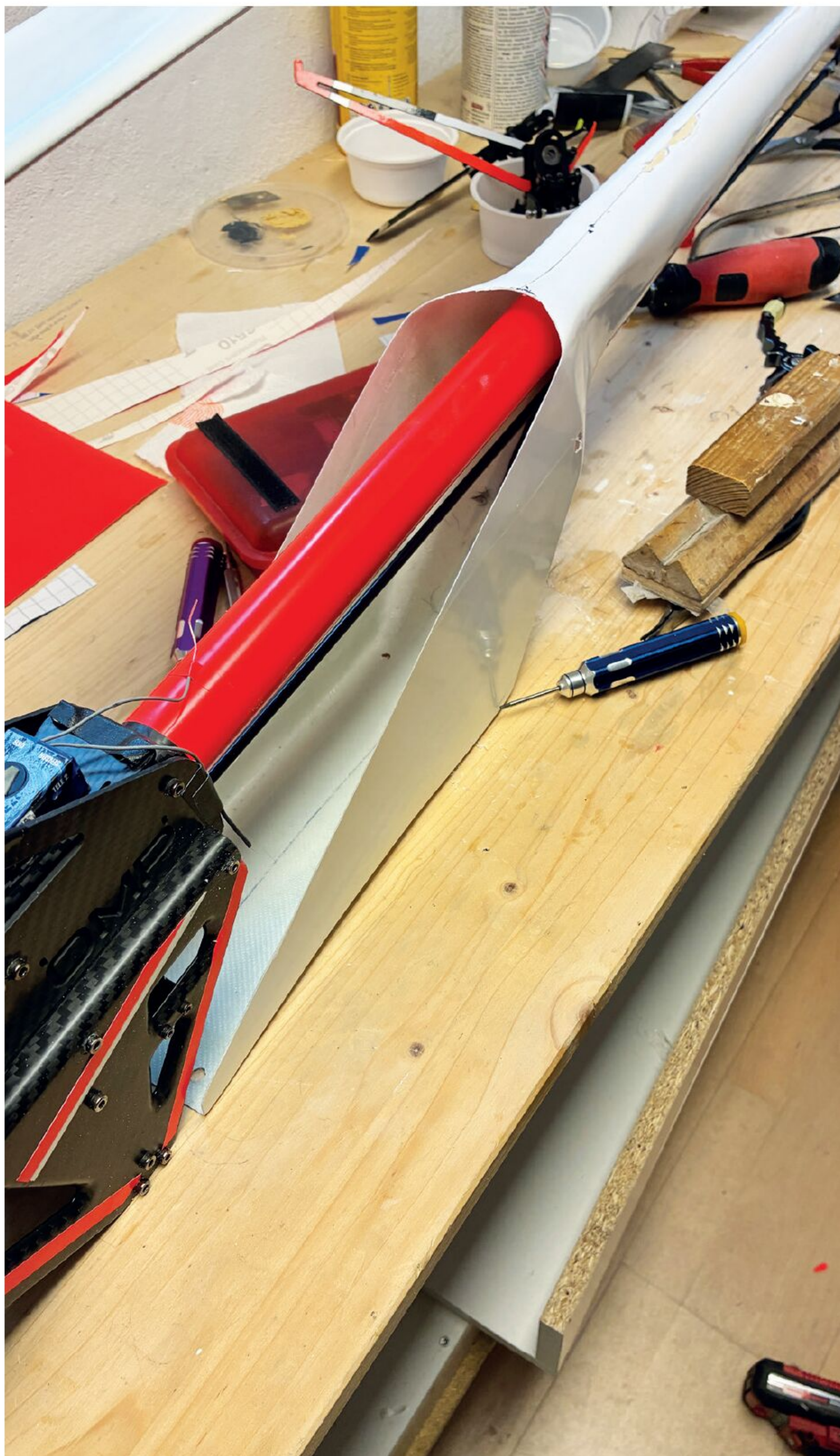
Einpassen der Mechanik mit dem Heckgestänge in den vorbereiteten Schlitz.
