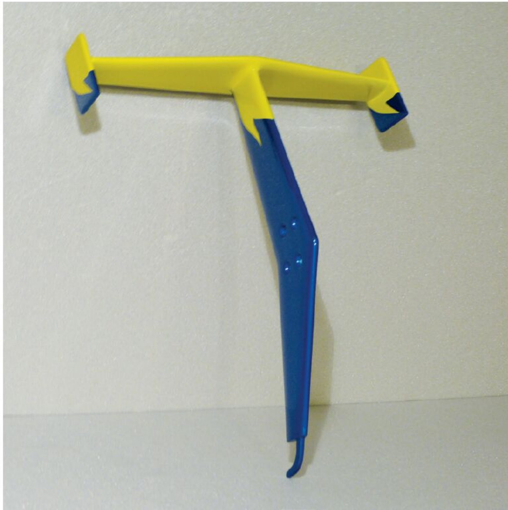
Die Kanzel kommt fertig lackiert mit der getönten Verglasung sowie den montierten sechs Führungsstiften und den vier Haltemagneten aus dem Karton.
