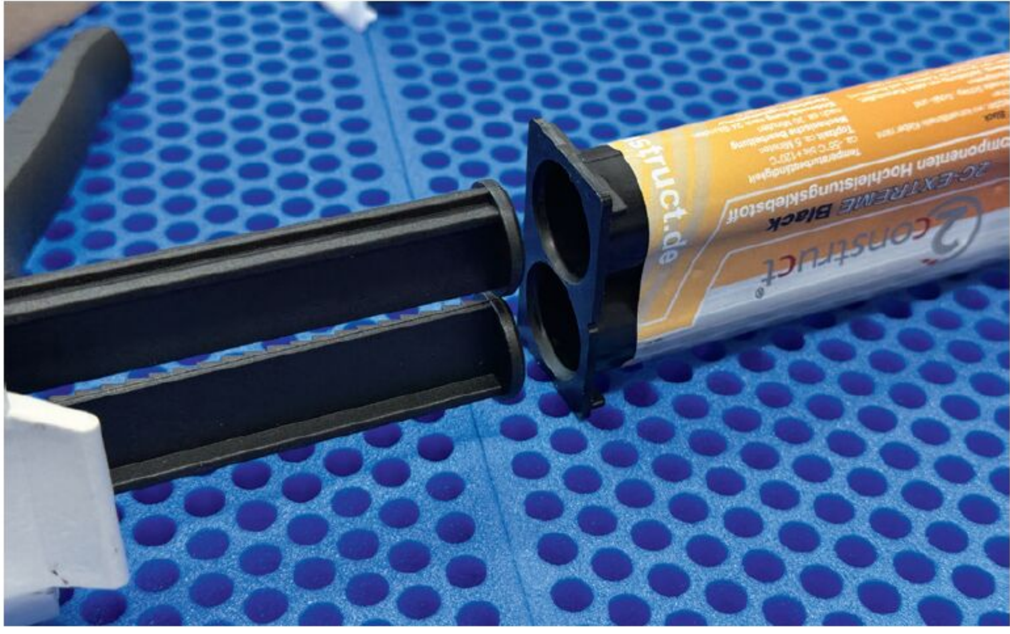
Die beiden Schieber laufen komplett parallel und sorgen für ein gleichmäßiges Mischungsverhältnis.
