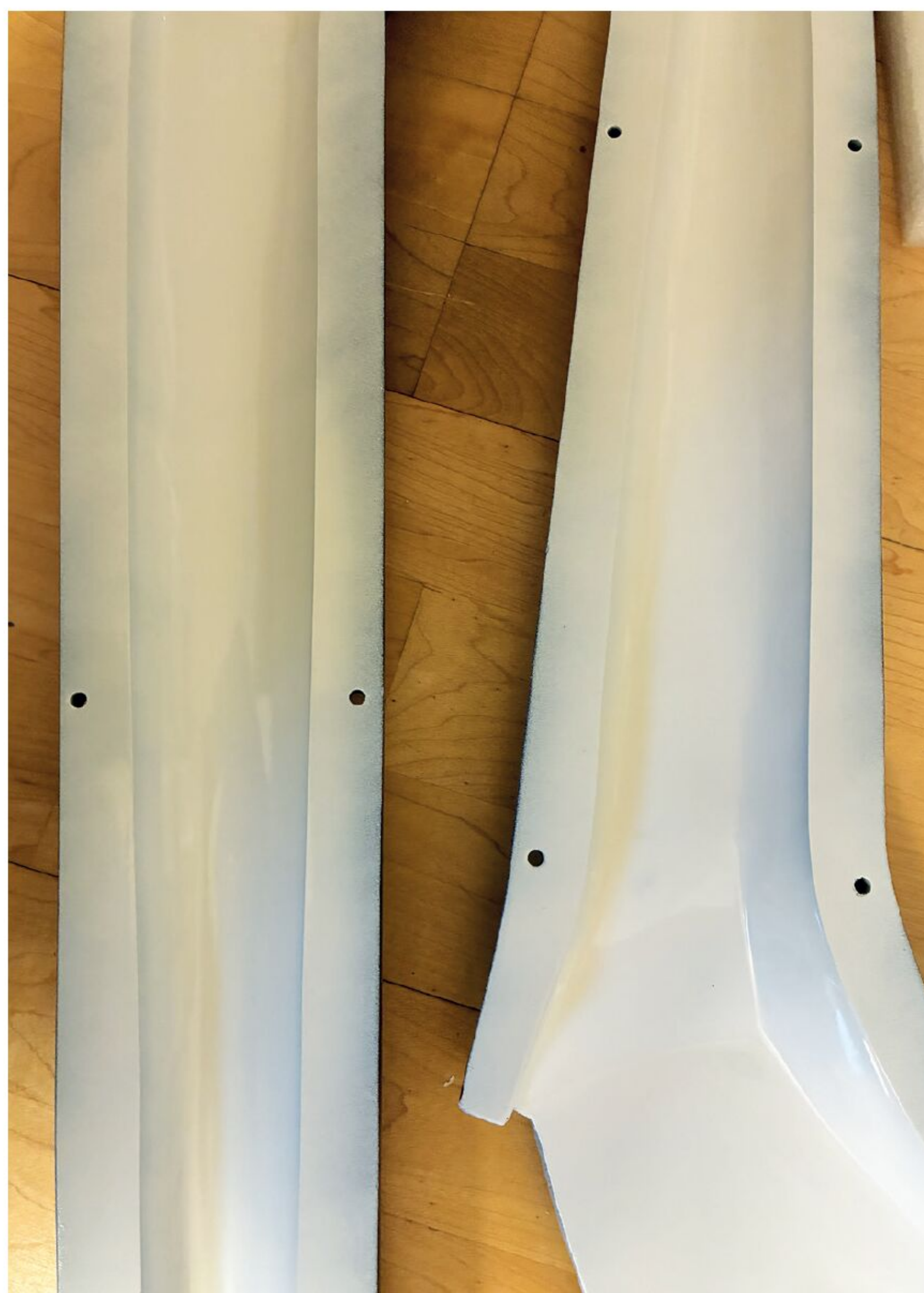
So sehen Negativformen nach dem Einlackieren des IMC-PU-Lacks in Signalweiß aus.
