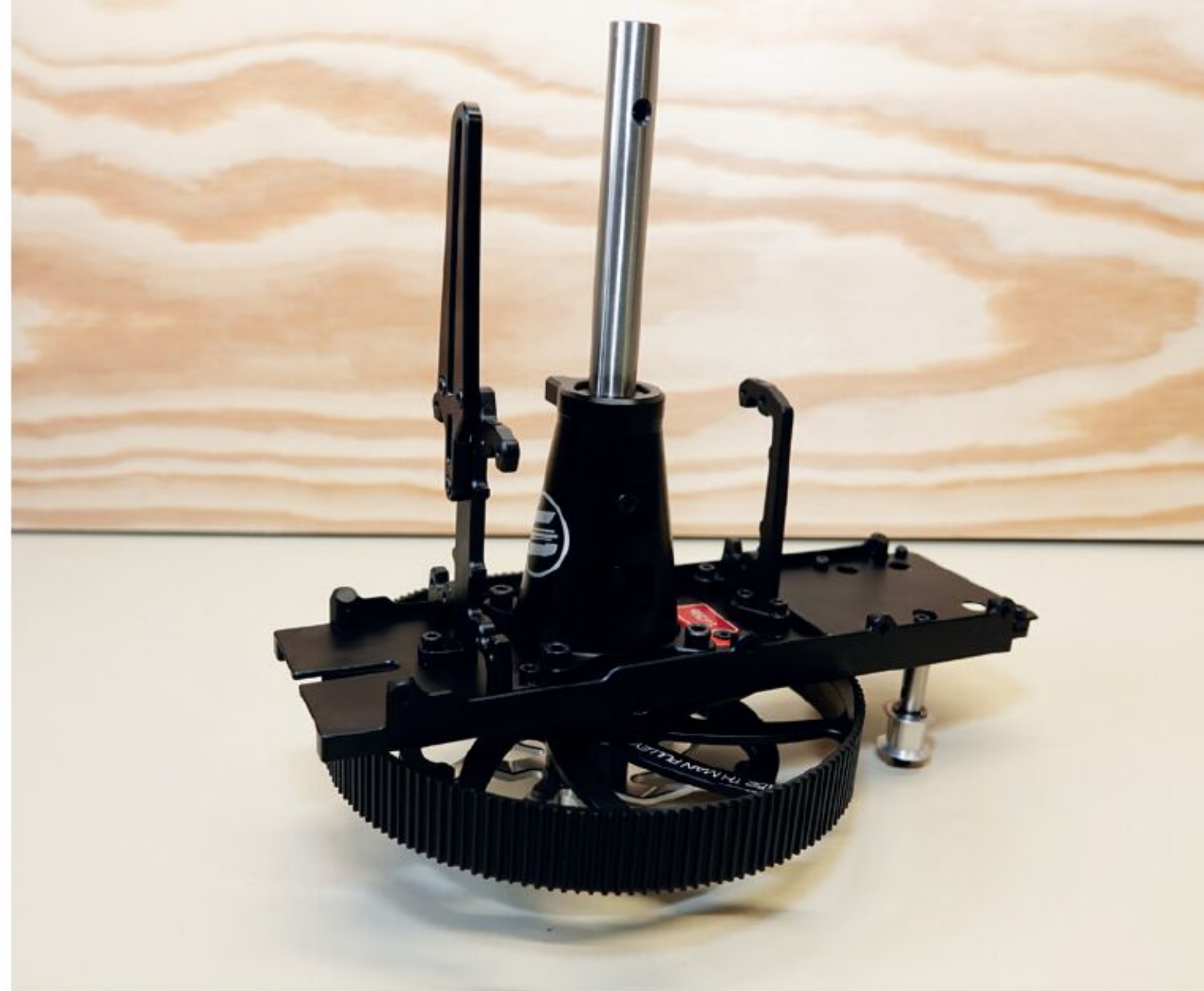
Das fertig zusammengebaute Getriebe mit der Chassis-Grundplatte und den Haltern für die Taumelscheibenservos.
