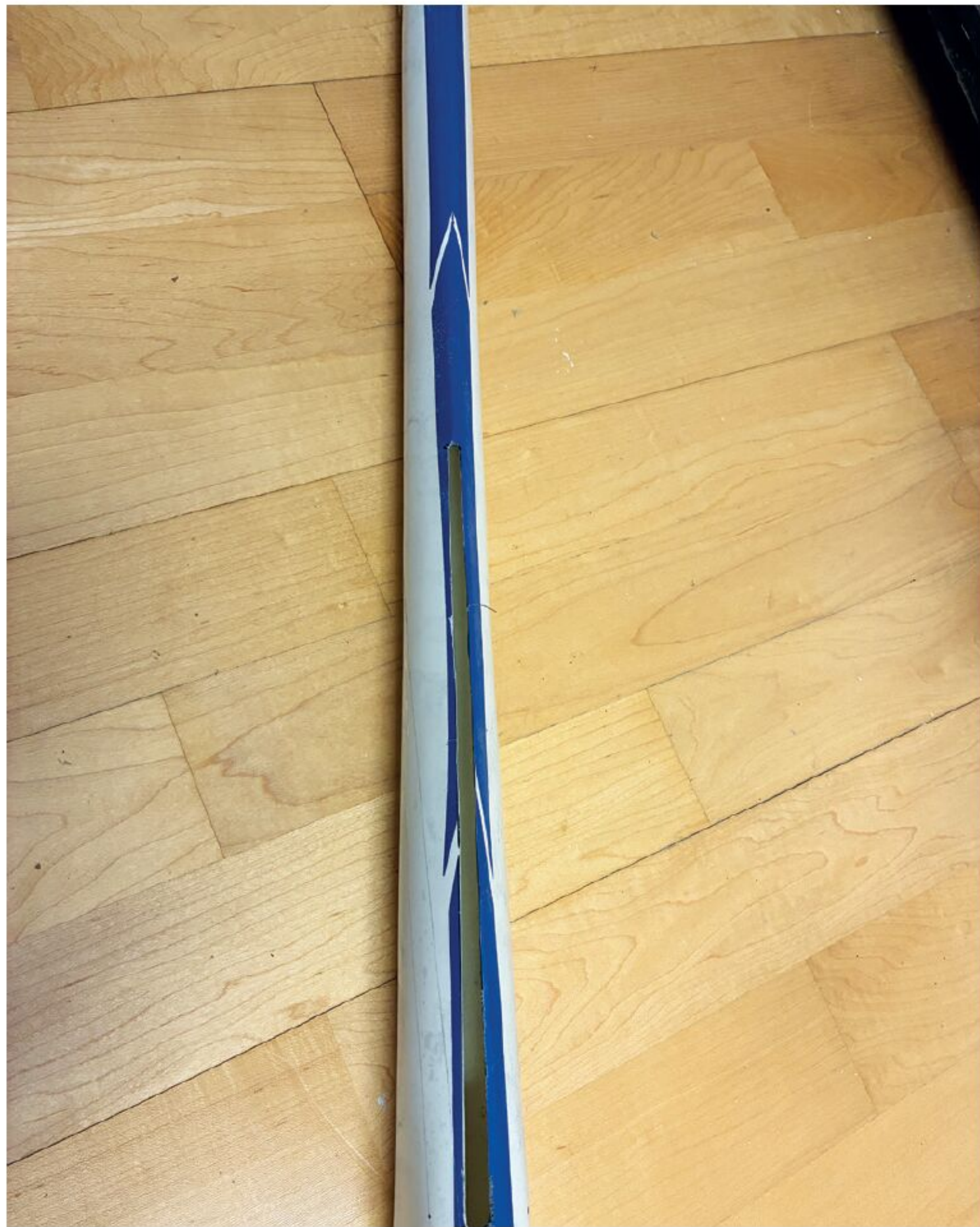
Der geschlitzte Heckausleger für die Durchführung des Heckgestänges.
