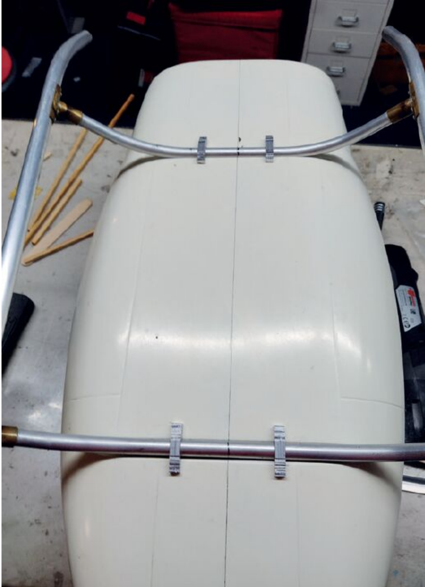
Die Halter für das Kufenlandegestell habe ich in Anlehnung an die Originalzeichnung aus Aluminium gefräst.
