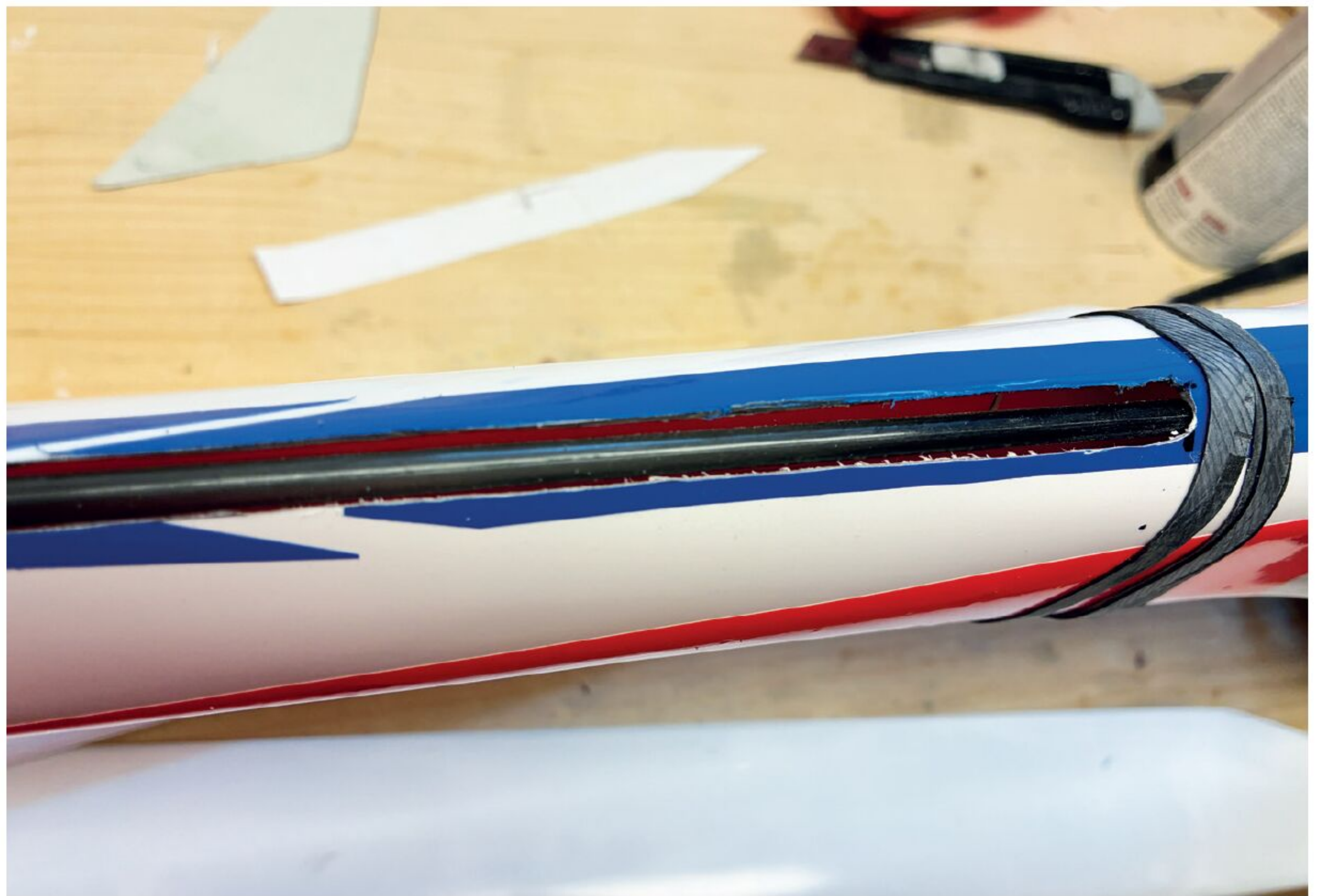
Der geschlitzte Heckausleger für die Durchführung des Heckgestänges.
