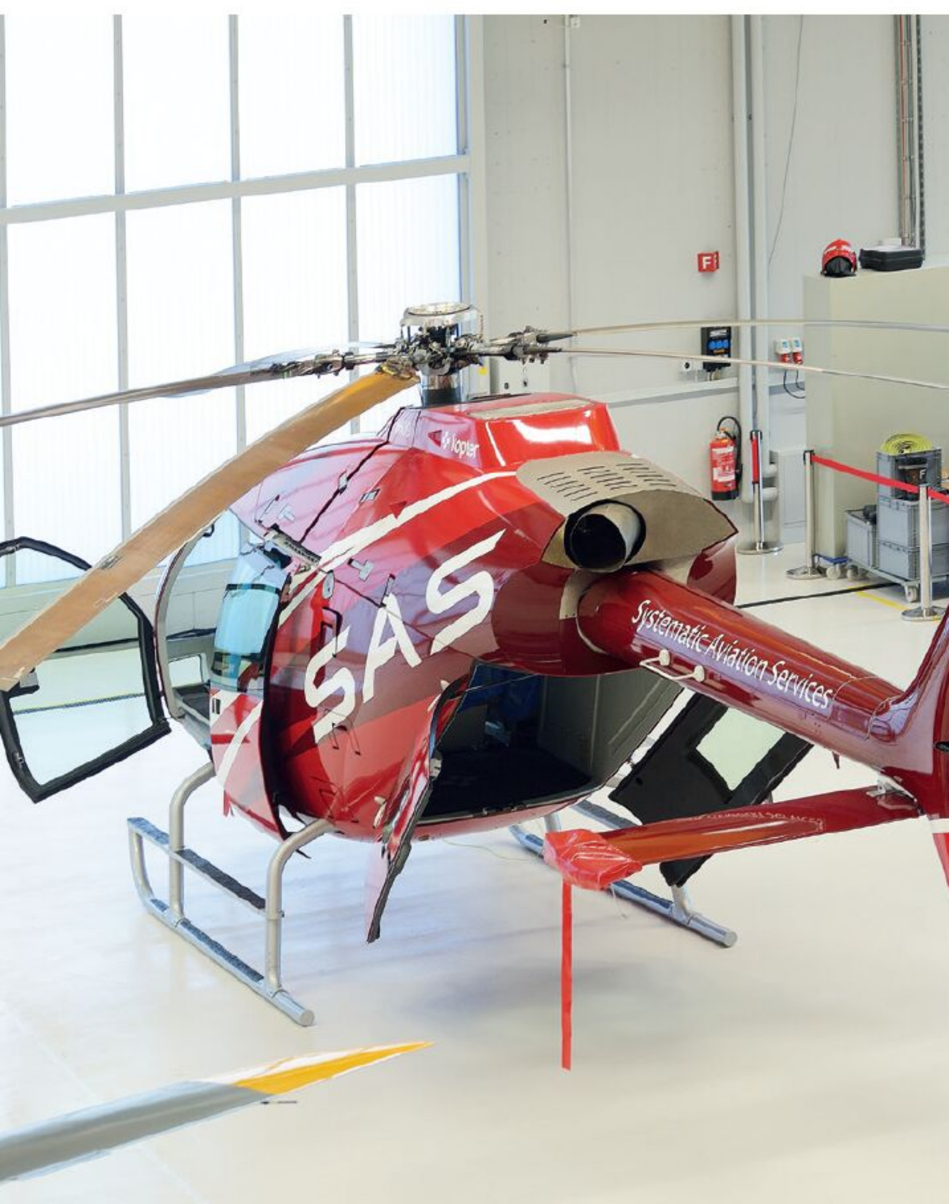
Der Fünfblattrotor sorgt für ruhigen Rotorlauf.
