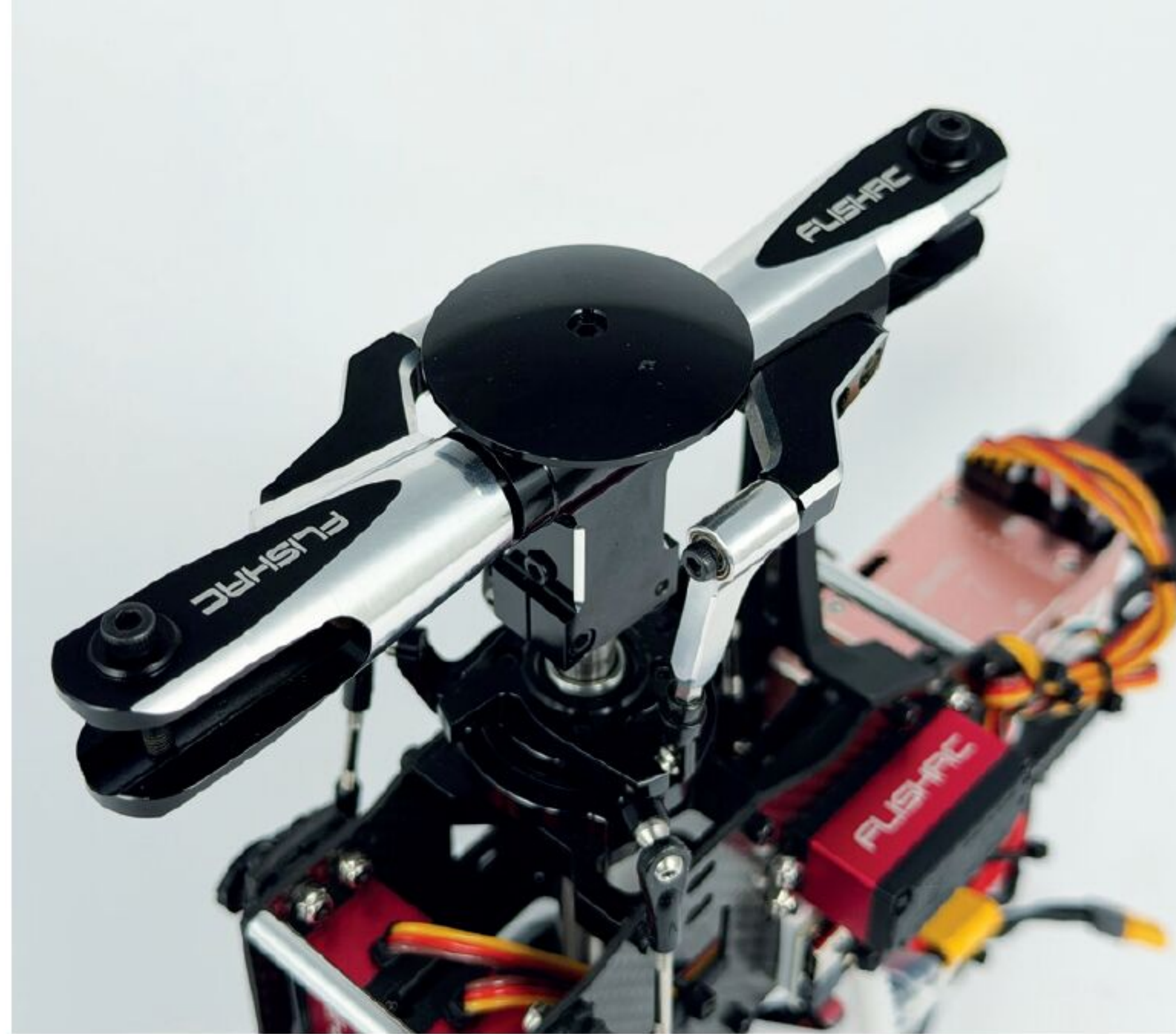
Der Rotorkopf und die Taumelscheibe bestehen komplett aus Aluminium.
