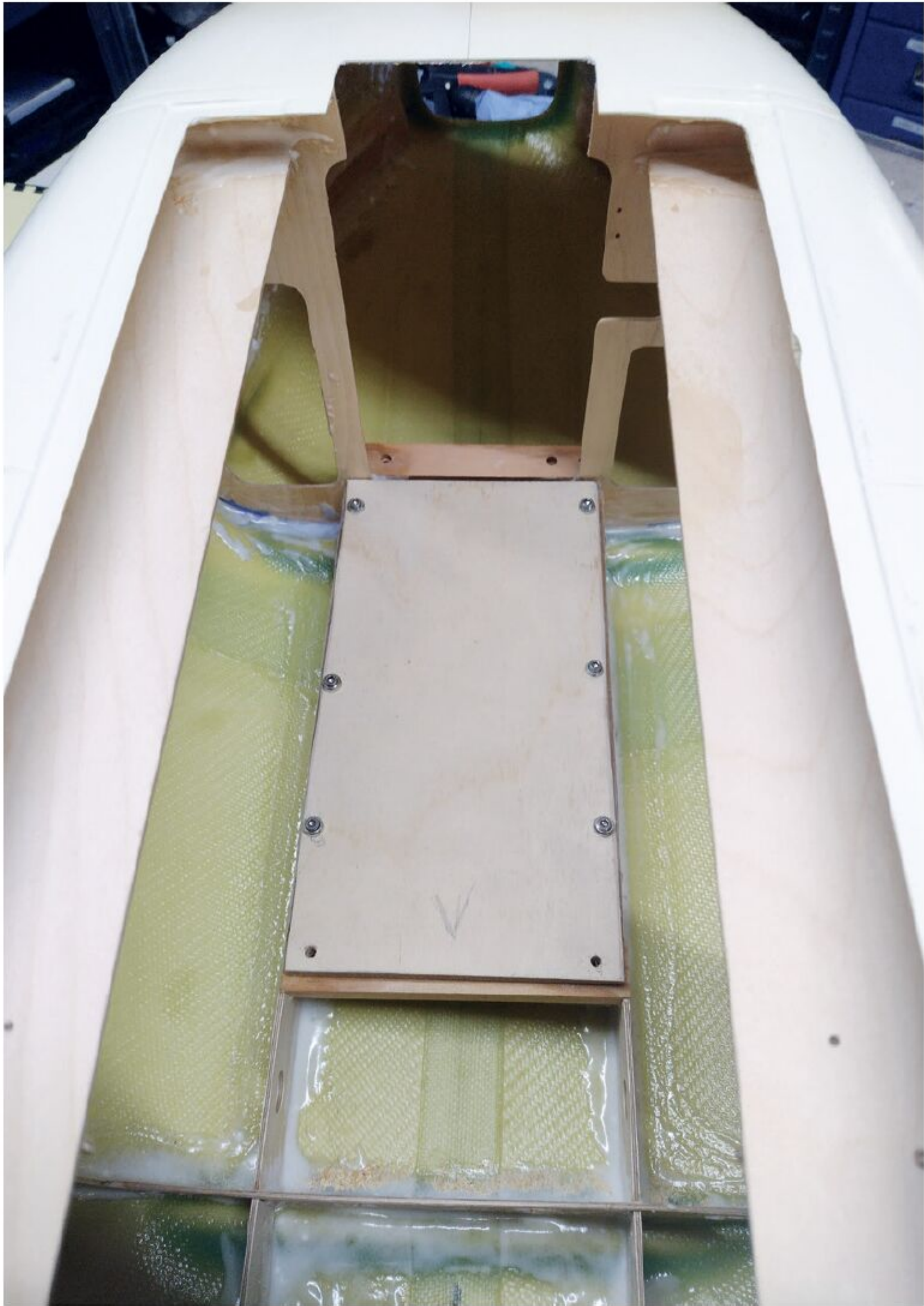
Auf den SSM-Spannten ist eine Sockelplatte aus Birkensperrholz zur Aufnahme der X-Treme-Mechanik eingepasst und verschraubt.
