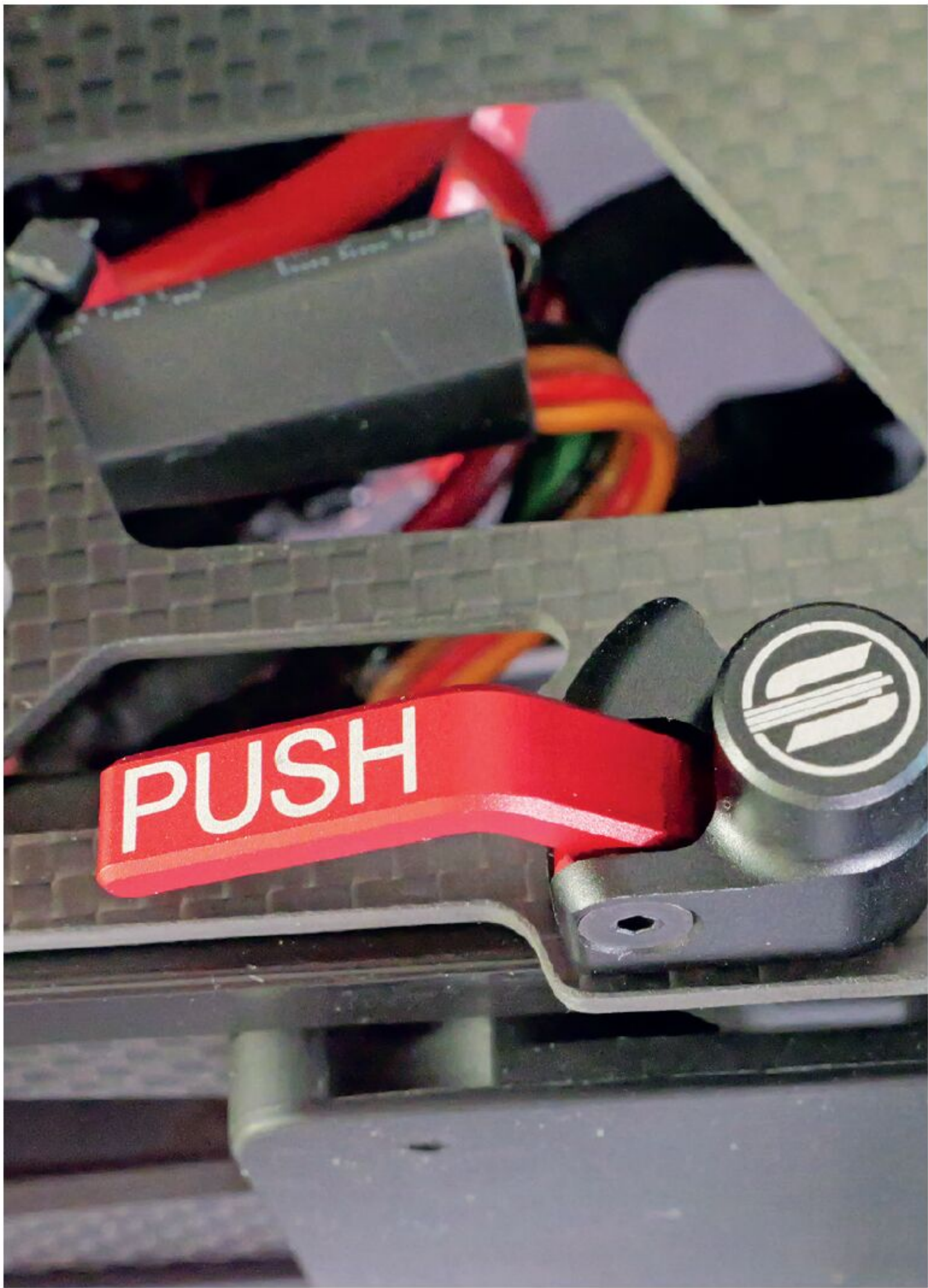
Der Verriegelungsbolzen der Akkuschiene rastet optisch wie haptisch sauber ein. Er ist gut zugänglich und überzeugt durch eine einfache, sichere Handhabung.
