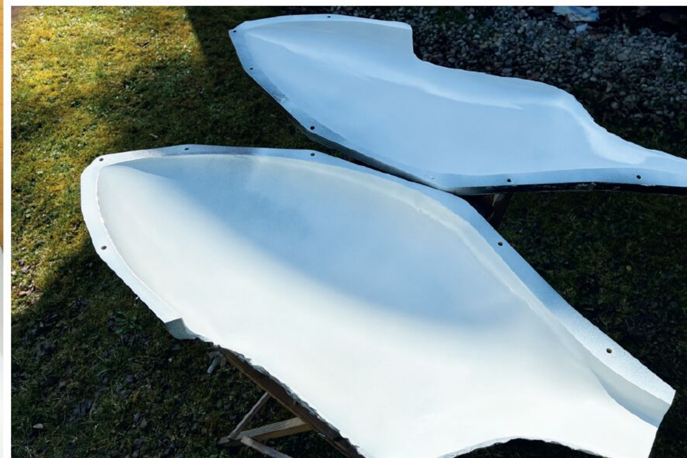
So sehen Negativformen nach dem Einlackieren des IMC-PU-Lacks in Signalweiß aus.
