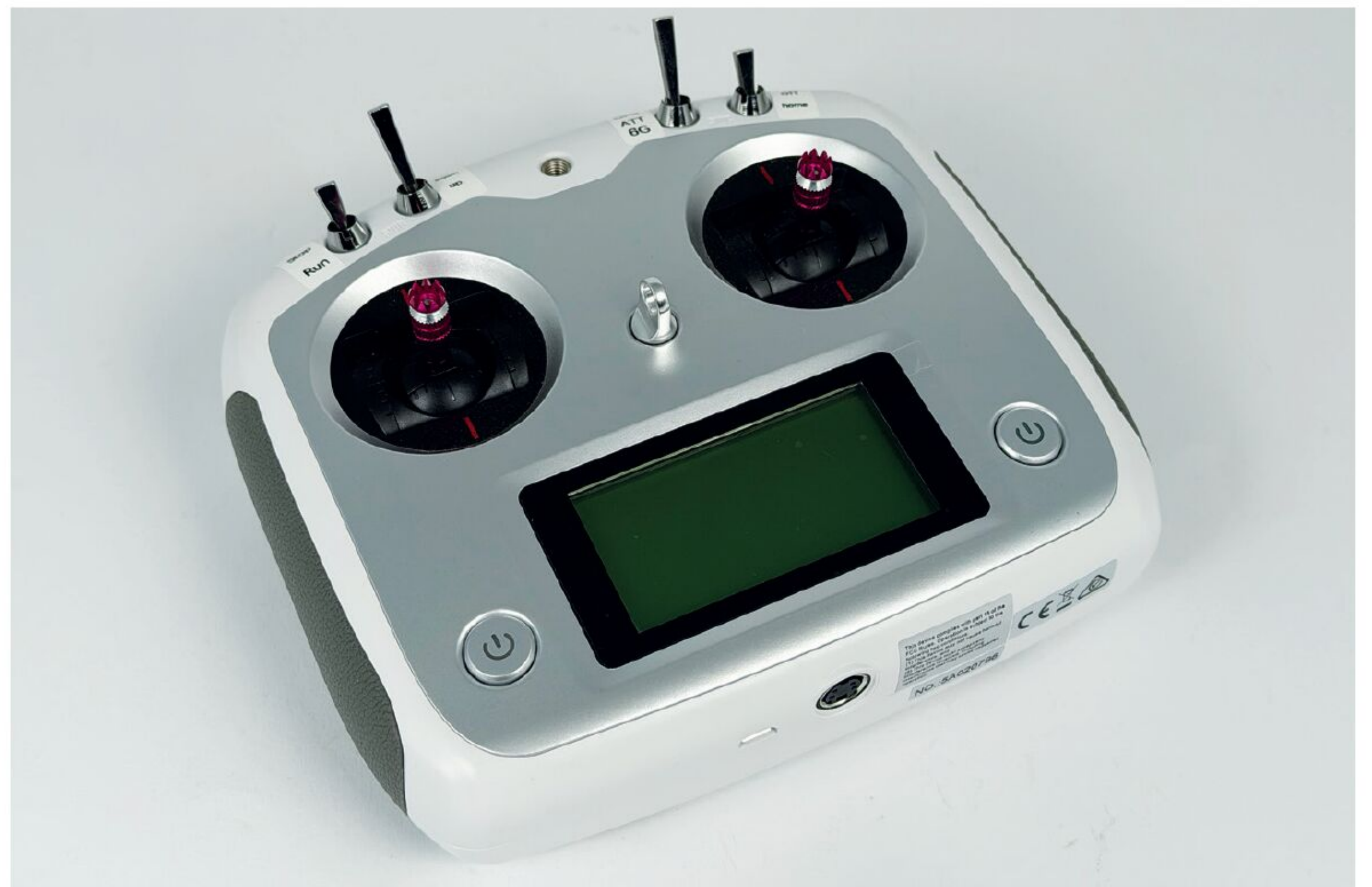
Auch wieder mit dabei: die FlySky FS-i6S 2,4-GHz-10-Kanal-Fernsteuerung. Diese ist in der RTF-Version vollständig auf den Airwolf eingestellt.
