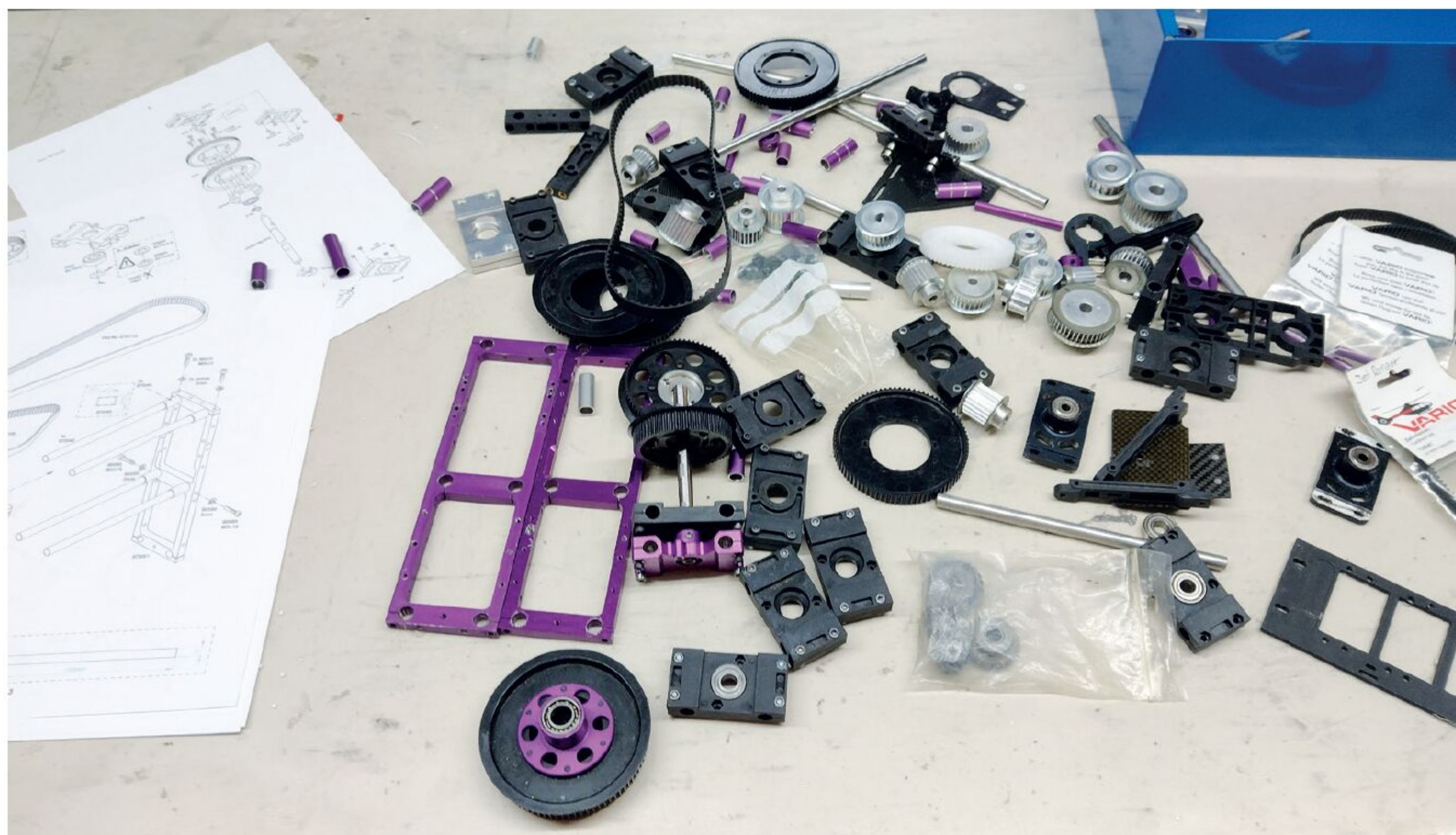
Für die fast komplette Vario-X-Treme-Mechanik musste nur ein Riemenrad und der E-Motor-Halter dazugekauft werden.
