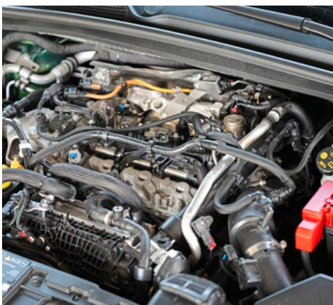
Ab Werk nackt: Auf dem Dreizylinder-motor sitzt keine Akustikhaube
