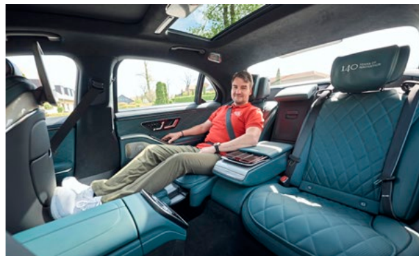
Fond-Manager: Der Sessel gleitet in Halbliegeposition, während der Beifahrersitz nach vorn rückt
