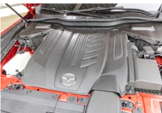
Plastikverpackt: längs installierter Reihensechser-Diesel
