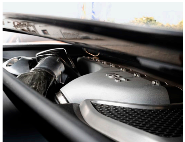
Statt mit vier seitlichen Turbos atmet der Achtliter-W16 aus Platzgründen durch zwei obenliegende Kompressoren
