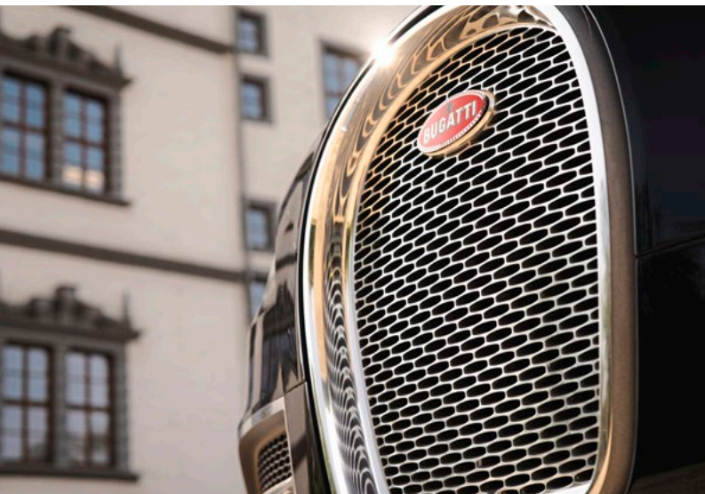
Einteiliger Aluminiumgrill, unterschiedlich bearbeitet. Von Hand. Das Emblem aus Silber war eigentlich für den Veyron gedacht
