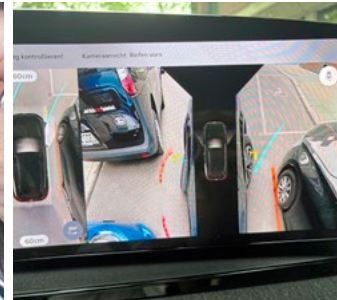
Top: auf die Vorderräder gerichtete Kameras mit der deutlich größten Darstellung im Testfeld
