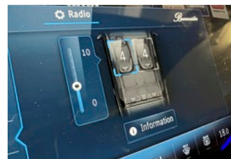
Quelle gefunden: der vibrierende Exciter im Fahrersitz
